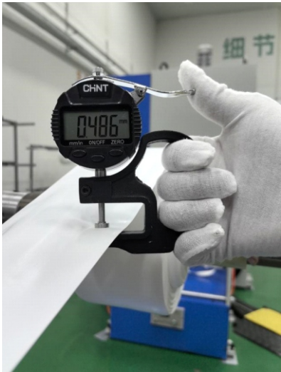
测量拉膜基带在脱脂拉伸后左右两端厚度是否在范围内
